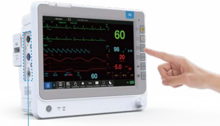
Multiple feature monitoring modules SpO 2 、ECG、TEMP、O 2 、WAKE、CO 2 、NIBP
